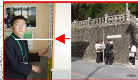
写真1 浸水痕跡調査の様子
