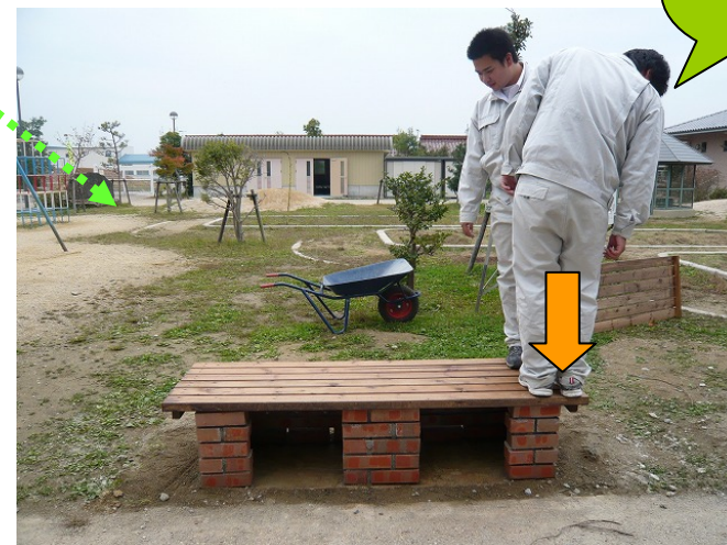
座板の浮き上がりの安定性確認
