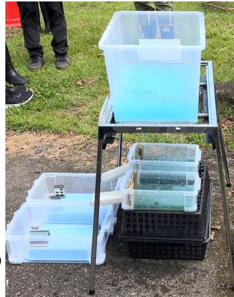
田んぼダムの貯水力 比較模型
