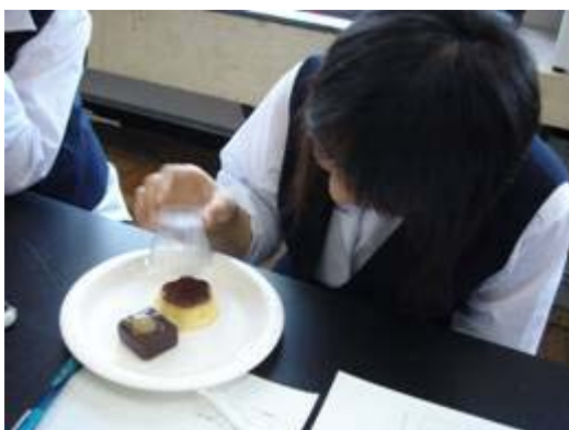
ようかんとプリンを家の下の地盤に見立てて、地盤とゆれの関係を見ました。
